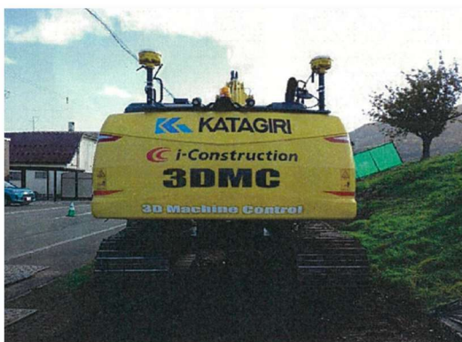
ICT 建機での施工により、従来機に比べ燃料消費量を約15%削減できCO2排出量を削減
