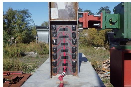
写真3.3 ひずみゲージ貼り付け状況
