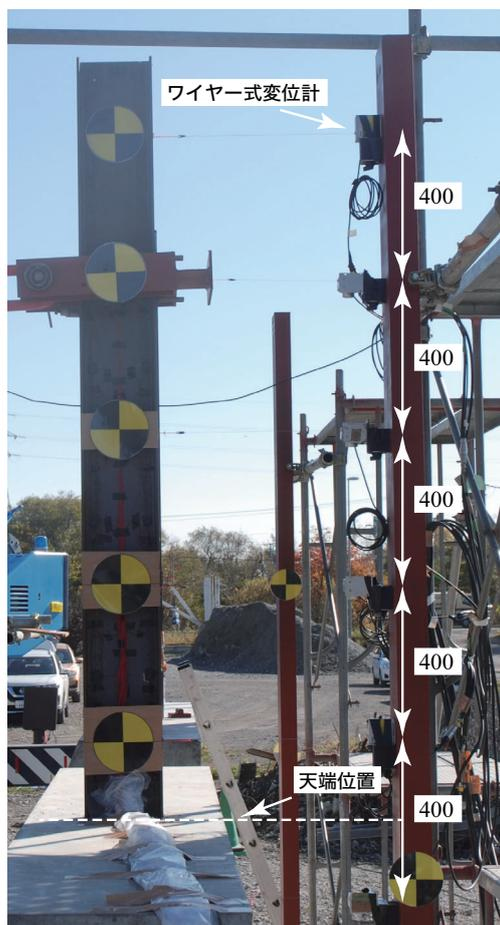
写真 2.2 ワイヤー式変位計の設置位置
