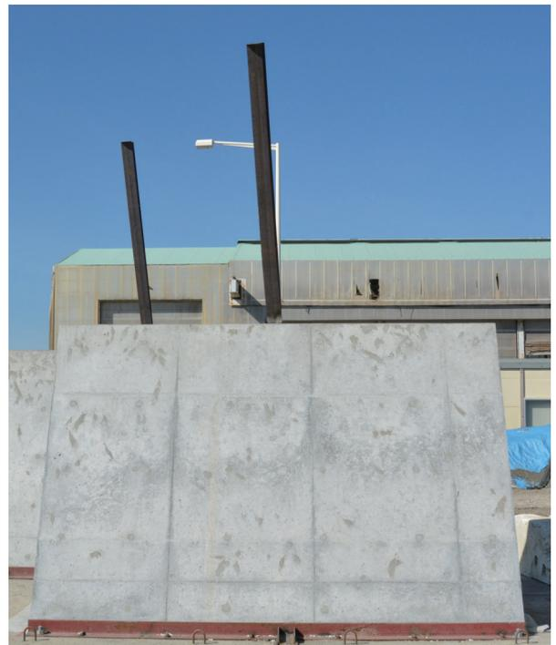
写真 3.7 PS 試験体の  $H = 4$  m の場合における実験終了後の支柱全体の変形状況
