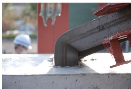
(d) PS試験体の基部の変形状況-2
