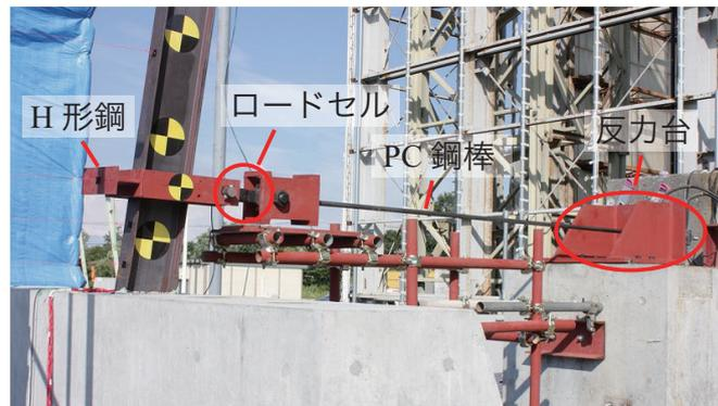
写真4.4 PS7-S 試験体の載荷状況
