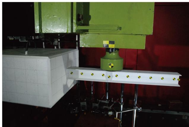
写真 1.2 室内での衝撃荷重載荷実験
