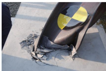
(c) PS試験体の基部の変形状況-1
