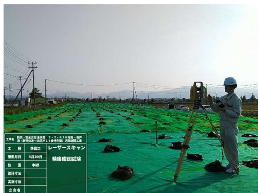
地上型レーザーキャナーを用いた起工測量
